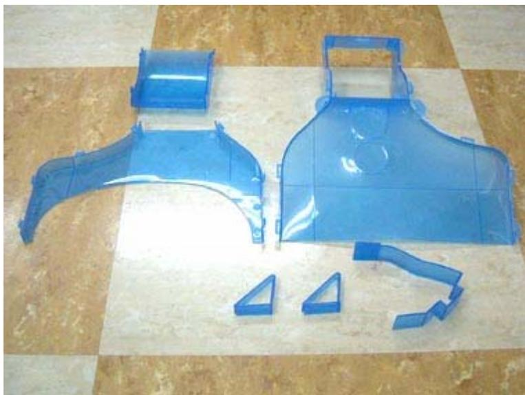
CV-1 を分解。外側のカバーが上下で分割でき、CPU 側のファンが取り付けやすくなっている
